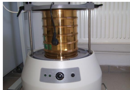
Set site pentru cernere cu actionare electrica
