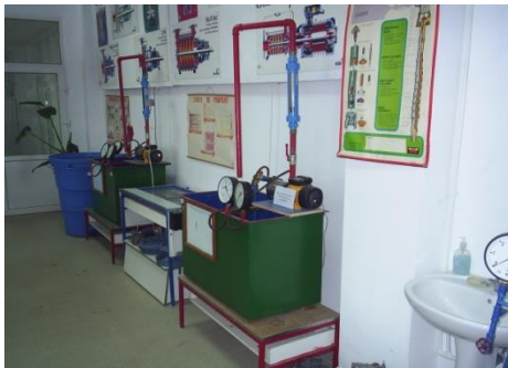
Instalatie pentru studiul functionarii pompelor centrifuge cu ax orizontal
