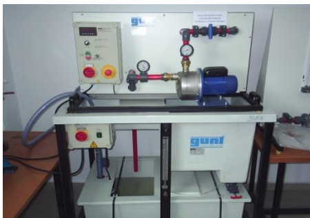
Instalatie pentru studiul functionarii pompelor actionate la turatie variabile
