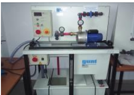
Instalație pentru studiul funcționării pompelor acționate la turatie variabile
