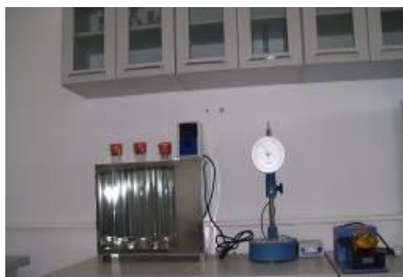
Baie cu temperatură constantă pentru determinarea granulozității prin metoda areometrului.
