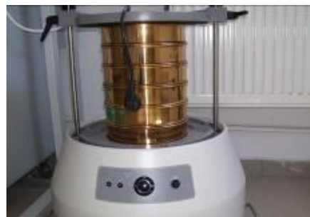
Set site pentru cernere cu acționare electrică
