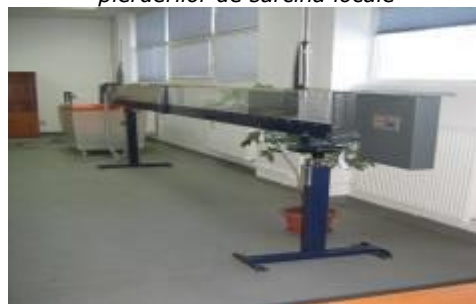
Canal pentru diverse măsurători hidraulice
