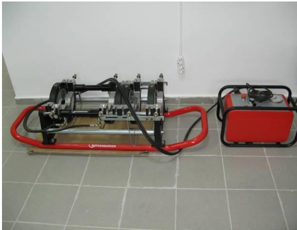
Aparat pentru sudura cap la cap a tuburilor PEID
